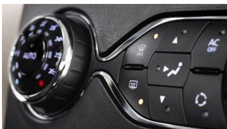
Система климат-контроля автоматически поддерживает точно заданную температуру воздуха в салоне
